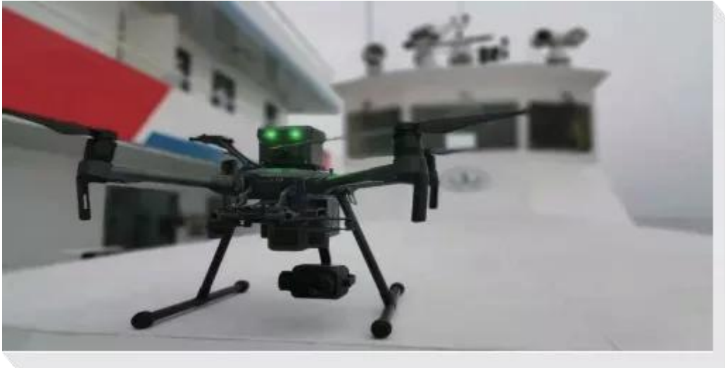
图 船舶尾气遥测无人机及机载嗅探设备
